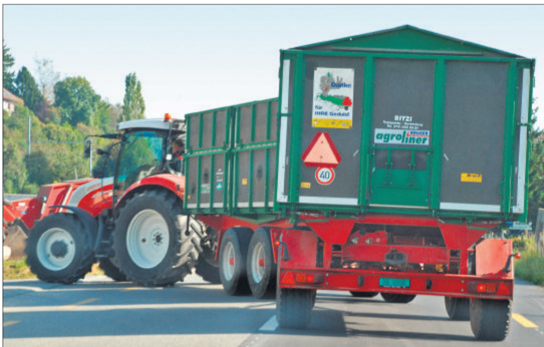
Unterschiedliche Bremsverzögerungen können zu gefährlichen Situationen führen. (Bild: röt)
